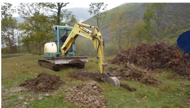
Figura 5. – La macchina impiegata per il campionamento: di fronte alla lama il cumulo, piccolo, del terreno di superficie; a ore 8 il primo metro; a ore 7 il secondo.
